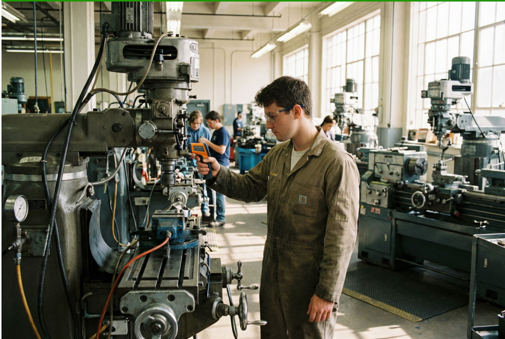
Mesure de température par capteur infrarouge, précision de 0,5 °C, temps d'échantillonnage de 5 minutes.
